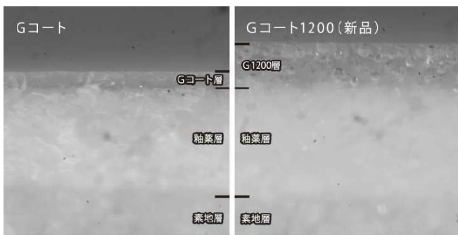
※新品のGコート便器の顕微鏡写真 ※新品のGコート1200便器の顕微鏡写真
